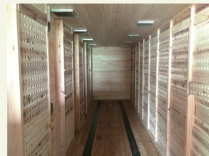
乾燥装置「愛工房」内
